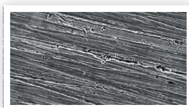
Неровная и грубая поверхность с глубокими царапинами
